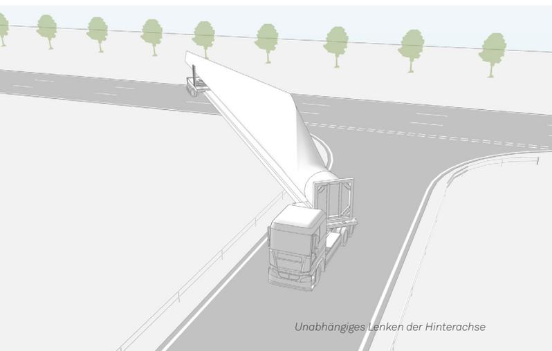
Unabhängiges Lenken der Hinterachse
